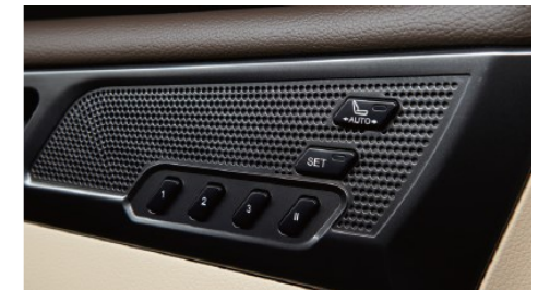
Fahrersitz mit Memory- und Komfort-Einstiegssystem Siège conducteur avec système d'accès à la mémoire et au confort Sedile del conducente con memoria e sistemi di ingresso comfort
